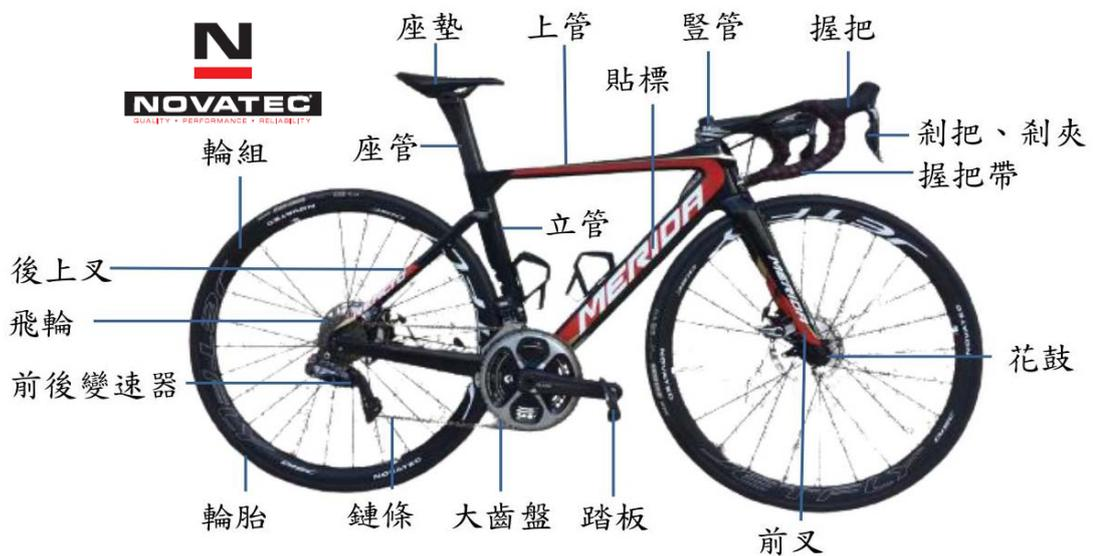
圖一(B) 電動輔助自行車結構圖
