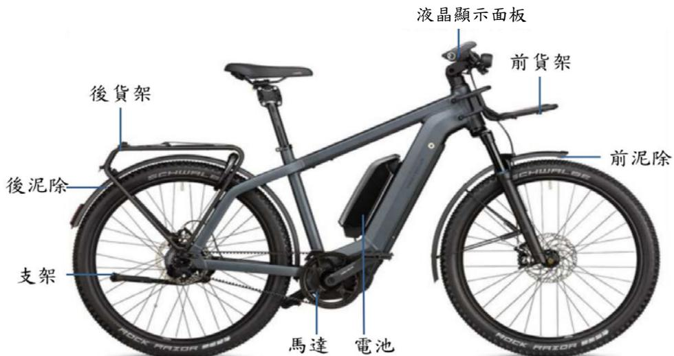
圖二 自行車系統與零件結構
