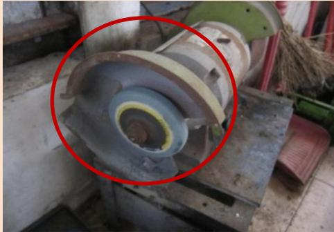
應有之護蓋未裝上，有砂輪片破碎飛擊傷人之危害
